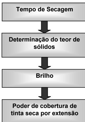
Figura 4 - Exemplo de fluxograma de ensaio de esmalte sintético Standard
